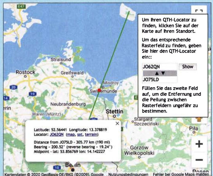
Bild 7: Diese Locatorkarte, Näheres s. Text, kann den Funkweg zu einer anderen Station veranschaulichen, hier zur dänischen Bake OZ4UHF in JO75LD auf Bornholm. Die Funkstrecke lässt sich überdies als Parameter übergeben, in diesem Fall: www.k7fry.com/grid/?qth=JO75LD&from=JO62QN&t=Foto und Screenshots: DL2RD
