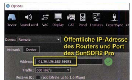
Bild 14: In ExpertSDR2 Remote ist auf dem Client-PC bei den Netzwerkeinstellungen des Transceivers die öffentliche IP-Adresse einzugeben (hier teilweise unkenntlich gemacht).
