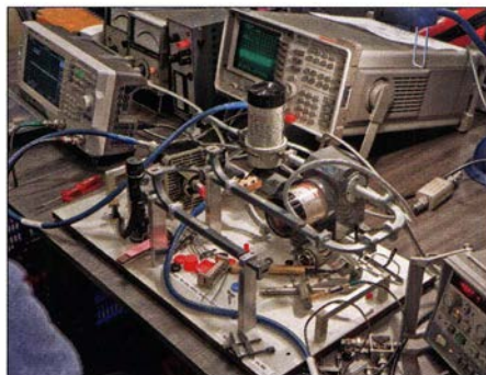
Bild 3: Zum Test von Eigenbautechnik stand z. B. ein Reflektometer für 18 GHz bis 26 GHz zur Verfügung.
