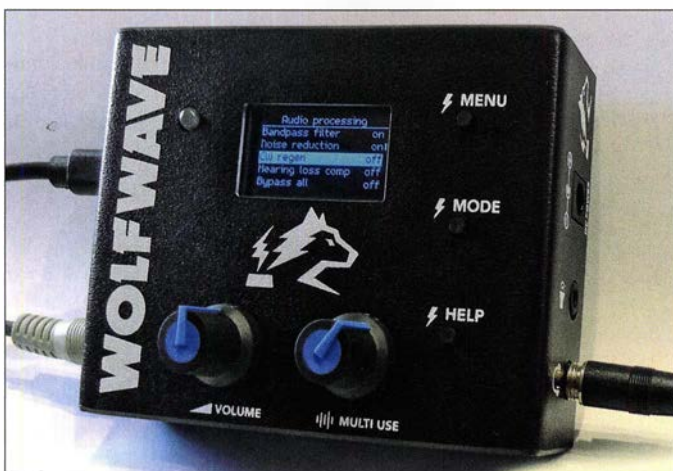
Bild 1: Der Wolfwave im Einsatz; das Display zeigt einen Teil der Menüstruktur; auf der rechten Seite befinden sich die Anschlüsse für Kopfhörer, passiven Lautsprecher und eine externe Stromversorgung.
