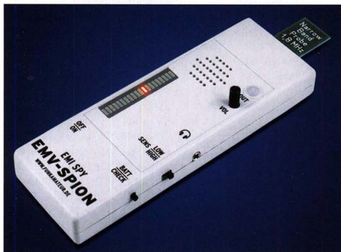
Bild 1: EMV-Spion mit aufgesteckter 1,8-MHz-Schmalbandsonde Fotos, Screenshot: PE3ES (2), Red. FA (2)
