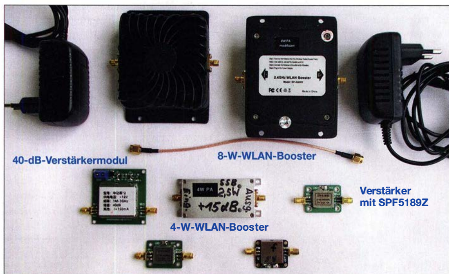
Bild 1: Getestet wurden unterschiedliche 2,4-GHz-Verstärkermodule für WLAN-Signale.
