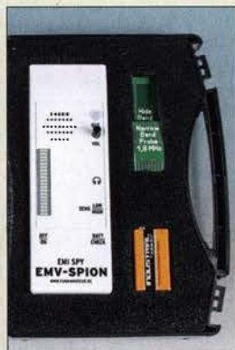
Beispielbestückung des Messgerätekoffers mit EMV-Spion, Messsonden und Blockbatterie
