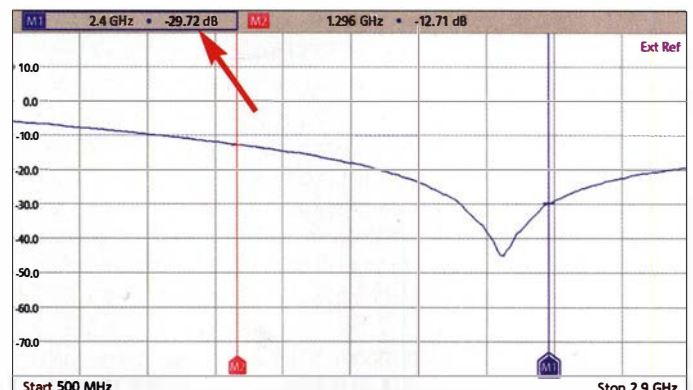
Bild 3: Die Entkopplung der Signaleingänge des ZAPD-21 bei 2,4 GHz beträgt leider nur 13,3 dB, ...
